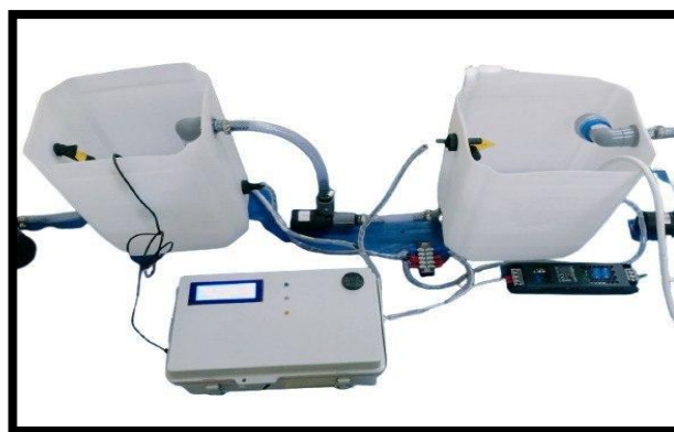
Rajah 1. Lakaran dan protaip IoT Pemprosesan Lada Putih
